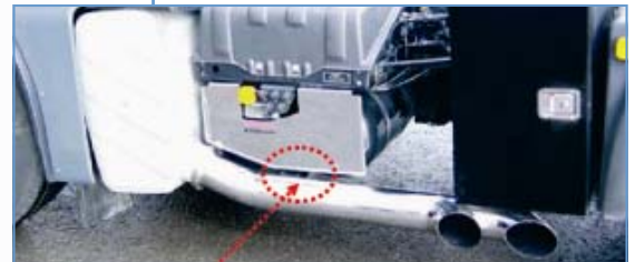
Anschluss der Wechselklappe !
